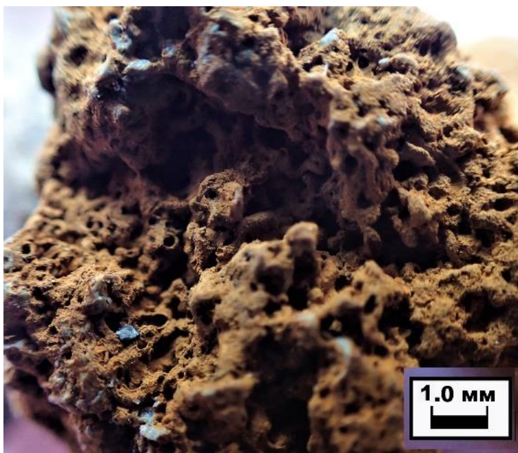
Рис. 10. Поверхность гераклитов после эксперимента, покрытая карбонатной корочкой с трубчатыми образованиями
