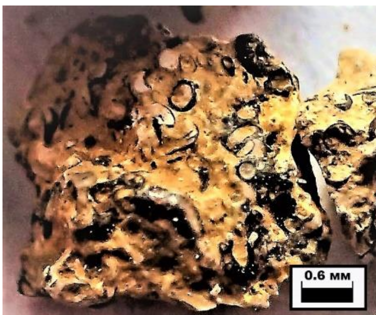
Рис. 11. Поверхность гераклитов со следами растворения и выщелачивания битумного и органического вещества
