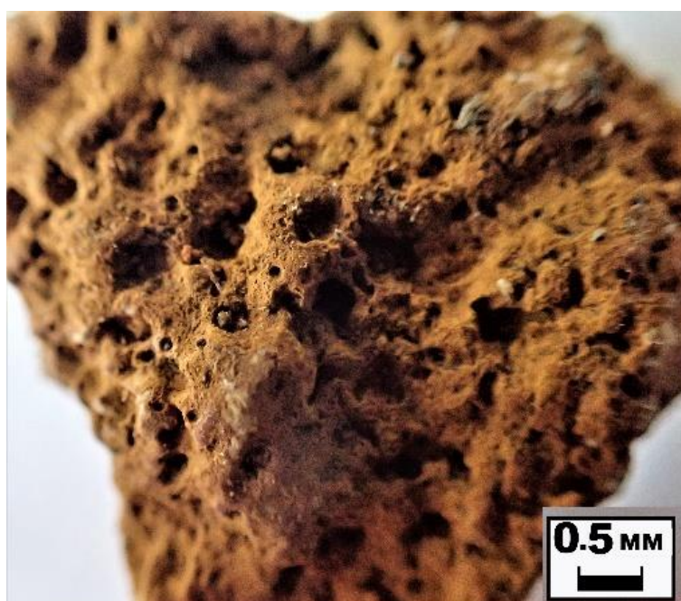
Рис. 9. Плоскость гераклитов после проведения опытов, покрытая плёнкой новообразованного кальцита с дырчатой поверхностью
