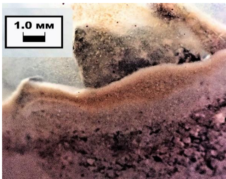
Рис. 17. Зональное строение бактериального обрастания. Верхняя подзона имеет розовато-оранжевую окраску, а нижняя – розово-белую
