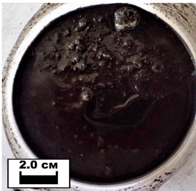
Рис. 2. Материал кислотного остатка растворения гераклитов после промывки его дистиллированной водой
