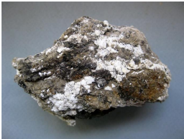
Рис. 1. Снежно-белые агрегаты alunита в ассоциации с гипсом на поверхности глинисто-сидеритовой конкреции. Образец 6,0x5,5x3,5 см.
